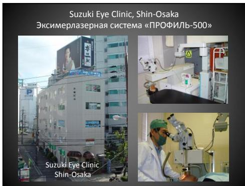
Suzuki Eye Clinic, Shin-Osaka. «Профиль-500» является уникальной системой и принципиально отличается от аналогичных. Одновременно проводится коррекция как сферического, так и цилиндрического компонентов миопии за счет формирования эллиптического профиля распределения лазерного луча с заданной пространственной конфигурацией и избирательного перепрофилирования роговичной поверхности.
